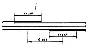
FIG. 4.5 STAGGERING OF LAP SPLICES
