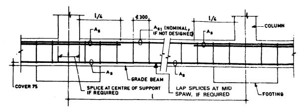
FIG. 6.13 TYPICAL LONGITUDINAL SECTION OF A GRADE BEAM
