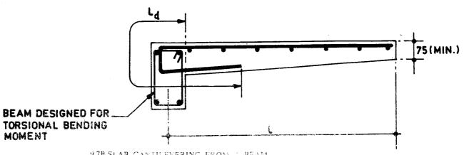
9.78 SLAB CANTILEVERING FROM A BEAM
