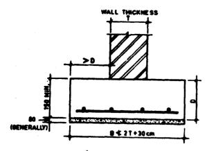
FIG. 6.5 STRIP FOOTING UNDER WALLS
