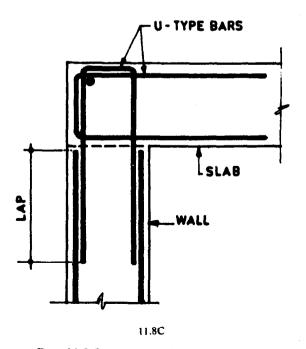
FIG. 11,8 SPLICES AT TOP OF WALL
